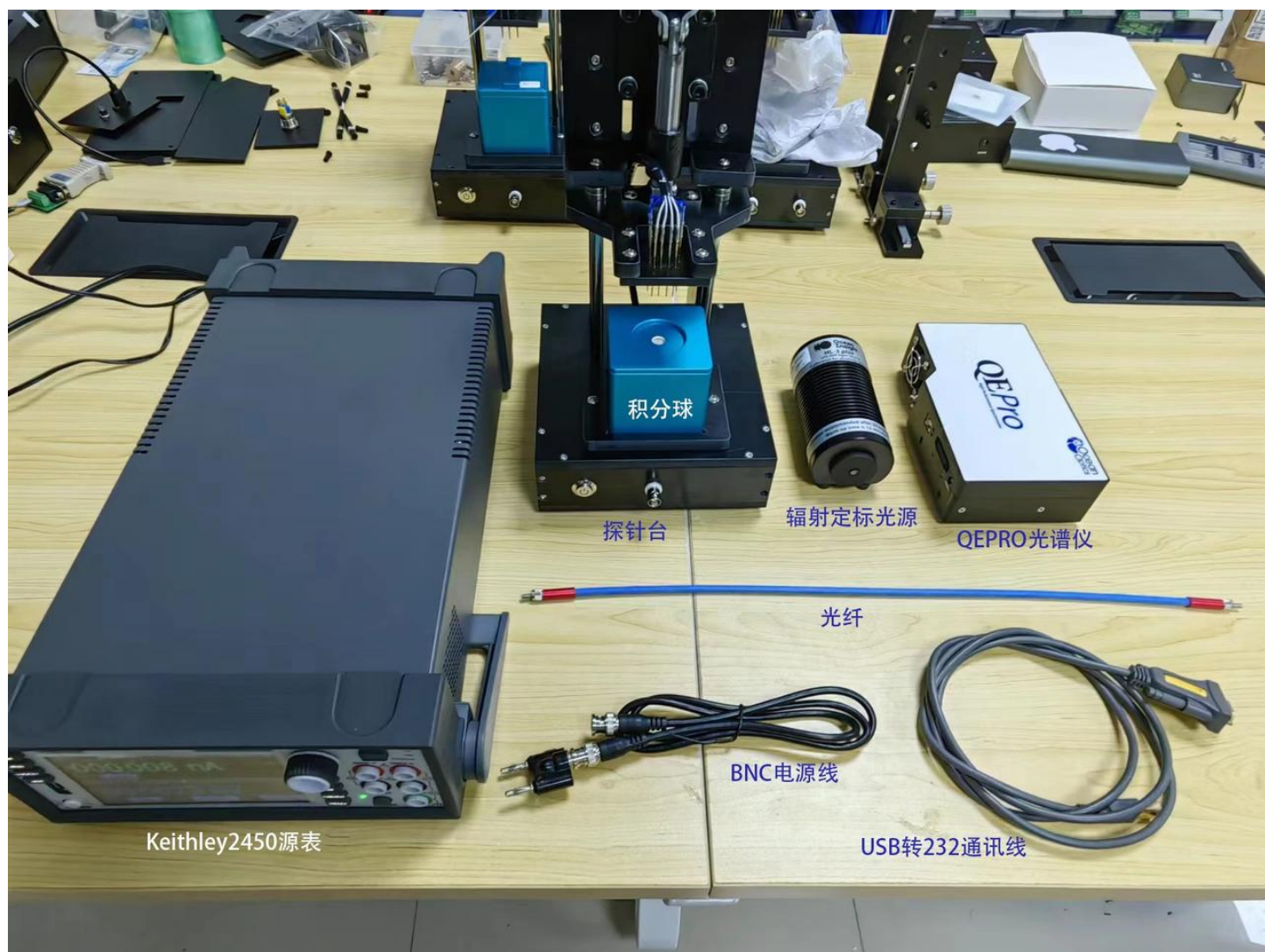
图1 EQE560测量系统组件实物图 and 对应名称
