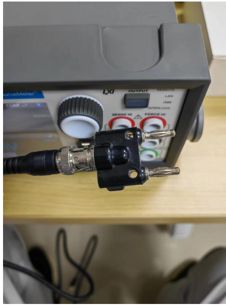
图3 探针台和源表连接
